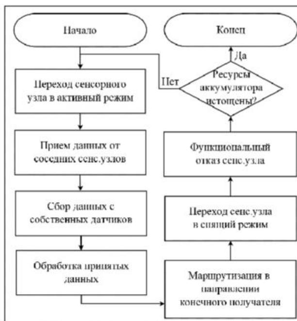
Рисунок 2. Схема работы сенсорного узла
