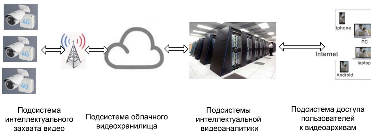
Рисунок. Структура облачной архитектуры системы видеонаблюдения.
