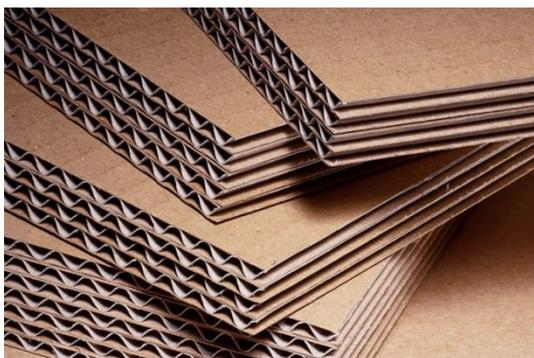
Рисунок 10. Структура картона
