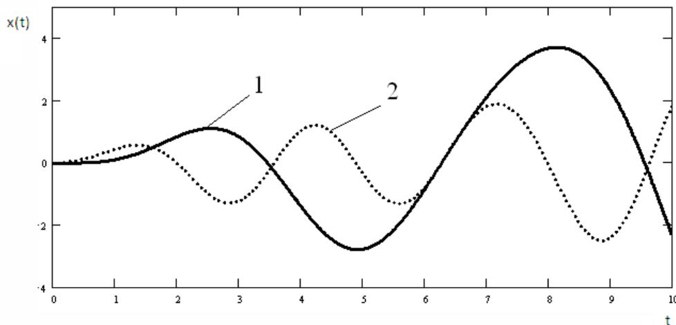
Рисунок 2. Иллюстрация зависимости  $x(t)$ , при воздействии силы, представляющей сумму нескольких гармонических колебаний с разными частотами
