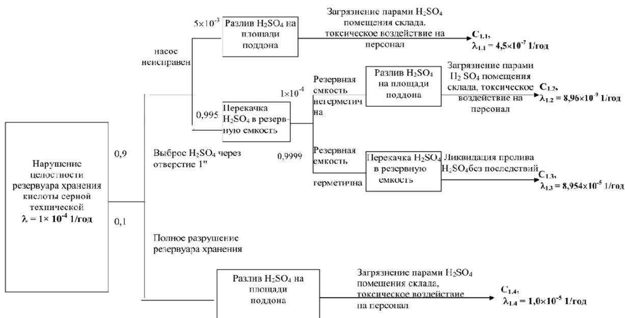
Рис. 1. Дерево событий при нарушении целостности резервуара хранения кислоты серной технической в Цехе улавливания химических продуктов коксохимического производства
