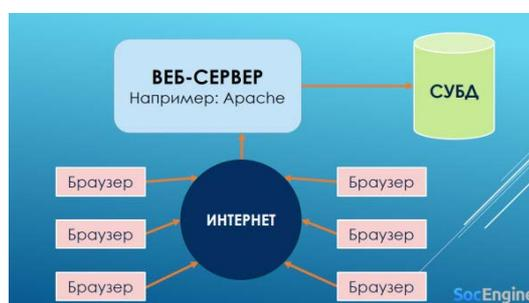
Рисунок 1. Схема работы веб-сервера.
